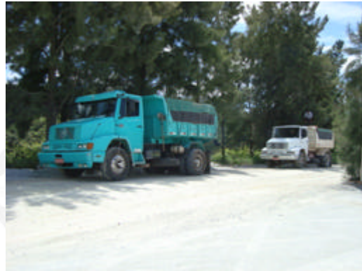
Foto 6 – Caminhão com uso de lona e implantação de cortina arbórea ao fundo
