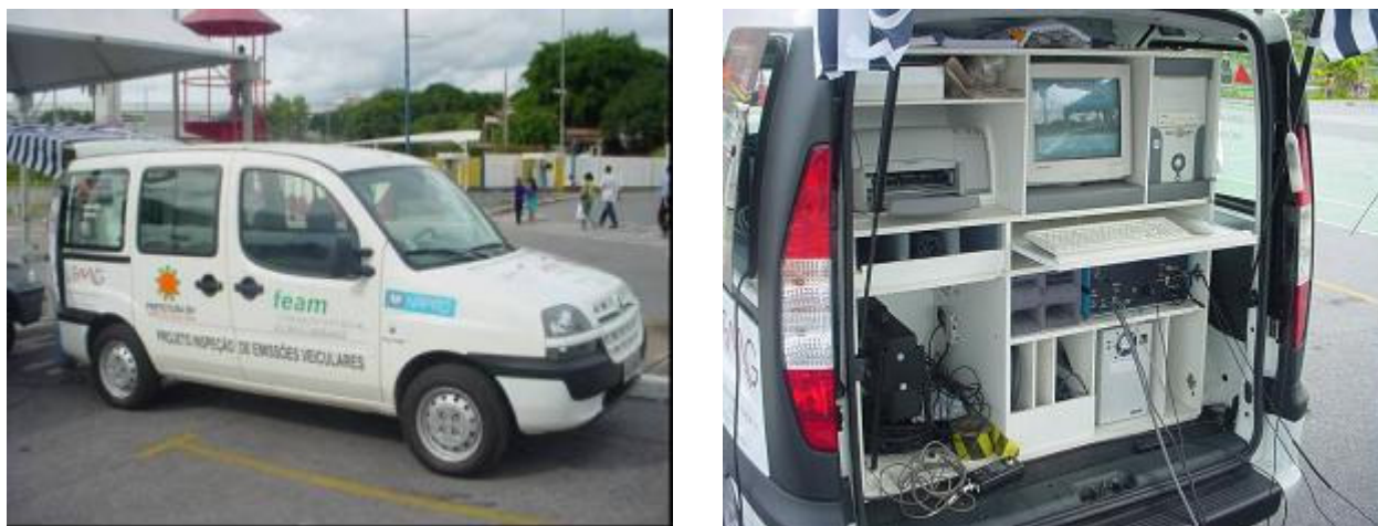
Figura 1 - Fotos da Unidade Móvel de inspeção de emissões veiculares
