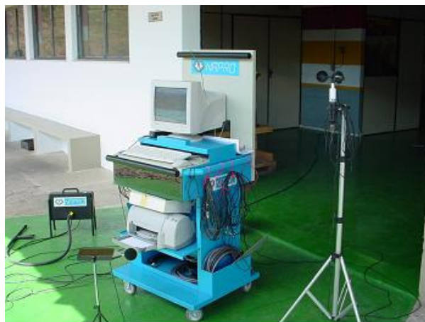
Figura 2 – Foto dos equipamentos de inspeção de emissões veiculares da Unidade Fixa
