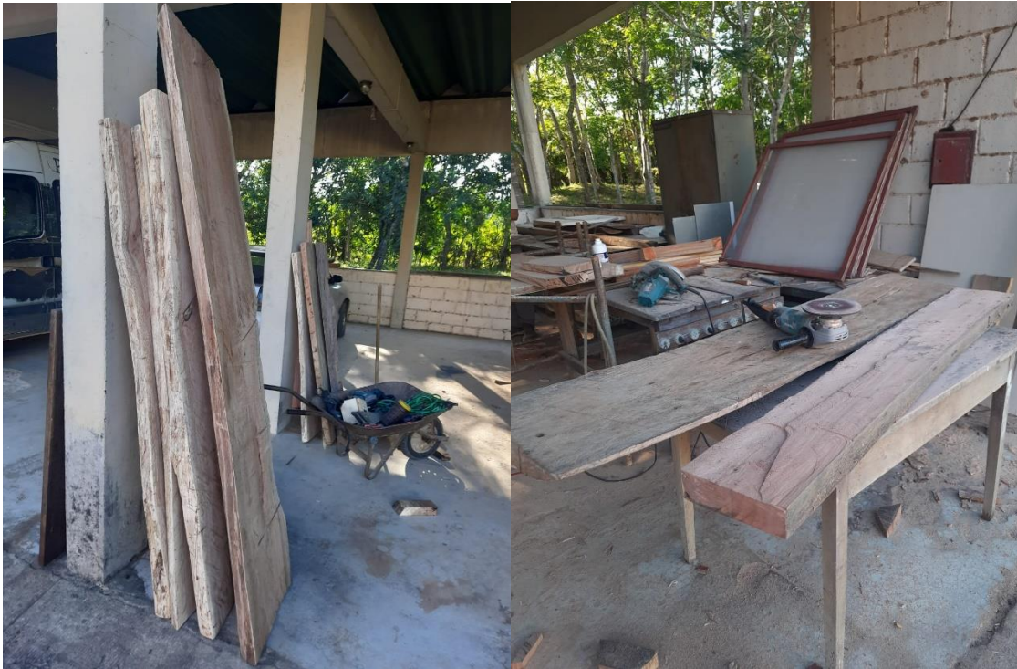
Figura 1. Mesas e Bancos: Preparações cuidadosas das madeiras ajustando os tamanhos e as formas das peças de acordo com as necessidades específicas, garantindo a adaptabilidade das mesas e bancos que serão confeccionadas para as áreas de camping.
