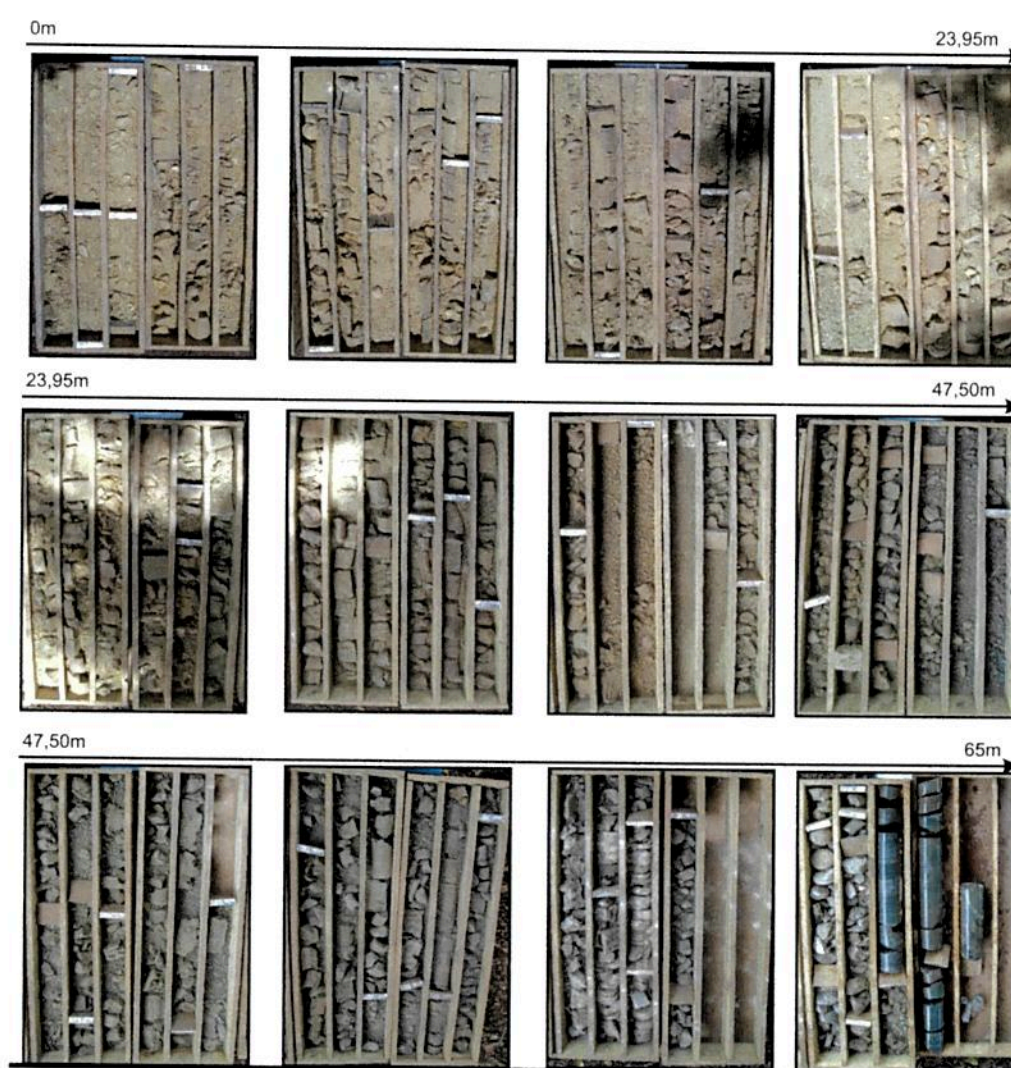
Figura 6.2: Testemunhos de sondagem do furo P-14, mostrando o perfil litológico típico da área do projeto.
